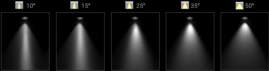
Verschiedene Abstrahlwinkel für architektonische Designs Five beam angles for various architectural design requirements.
